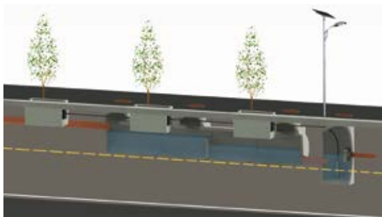
Foreva- fordøyning rensing og vanningsanlegg
